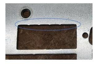
sichtbare Überreste von Mikroverbindungen (Micro-joint)
